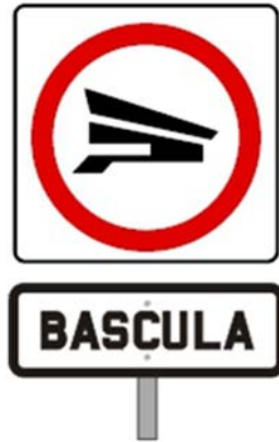
Ilustración 52. Señalamiento Restringido (SR-8)
